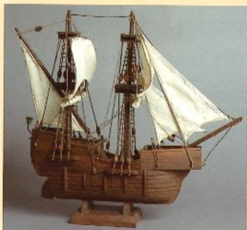
2. La caraque ou la nef, maquette, collection privée. C'est un navire gros porteur puisqu'il jauge entre deux cents et six cents tonneaux et qu'il porte jusqu'à quatre mâts équipés de voiles carrées et de voiles latines.
