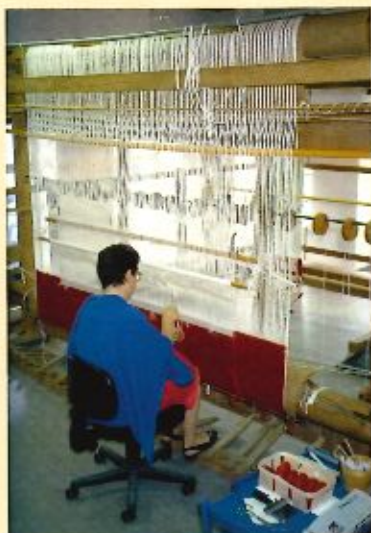
30. Métier à tisser. Lissière au travail sur un métier de haute lisse dans les ateliers du Musée de la Tapisserie à Tournai.
