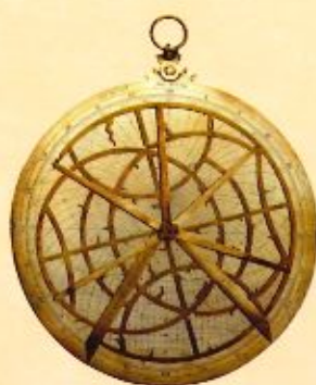
8. Astrolabe, bronze, XIII e siècle, diamètre 14,5 cm, Musée de la Vie Wallonne, Liège. L'astrolabe, « preneur d'astres » selon l'étymologie grecque, est un instrument hérité de l'Antiquité et perfectionné par les Arabes. Il sert à déterminer la hauteur des astres, notamment de l'étoile polaire, en vue de déduire la latitude. Il est constitué de deux ou plusieurs disques superposés et muni d'un anneau et d'un dispositif de visée.
