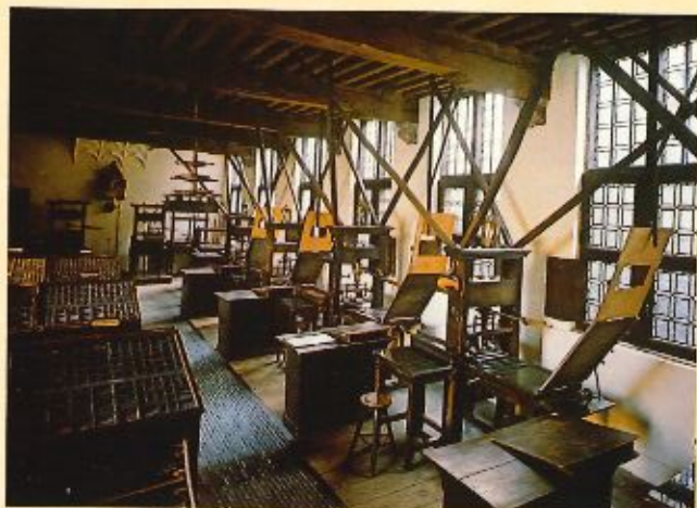
4. La salle des presses, Musée Plantin Moretus, Anvers. Entirement en bois, ces presses sont à l'image de celles utilisées aux premiers jours de l'imprimerie. Les « balles » de crin servent à encreur la forme.
