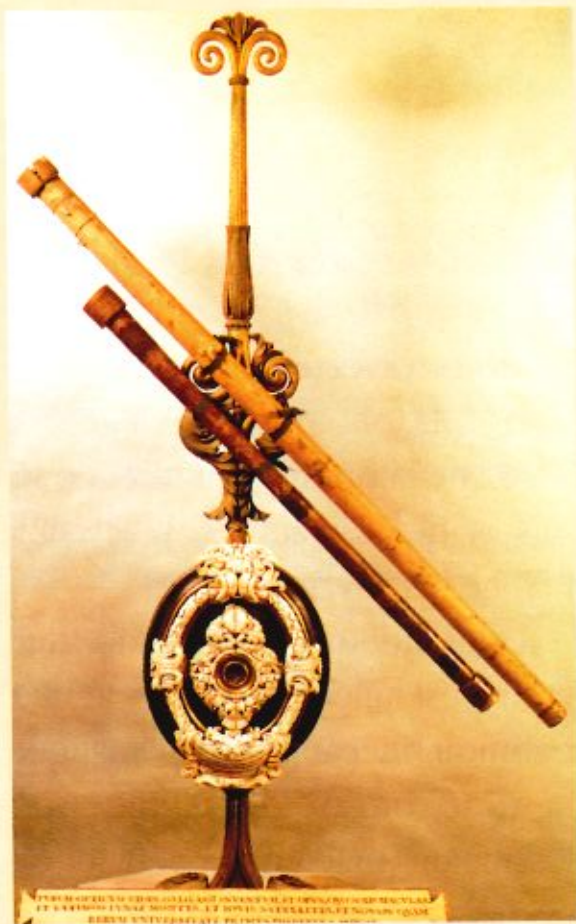
6. Lunettes de Galilée, XVII e siècle, Musée de la Science, Florence (Italie). La lunette est une association d'une lentille convergente et une divergente. Galilée n'en est pas l'inventeur, ce sont les Hollandais. Cependant, il les perfectionne empiriquement : le grossissement passe de trois à trente fois, l'homogénéité et la transparence des verres sont améliorées. Sur cette photo, la lunette du haut grossit quatorze fois, celle du bas vingt-et-une fois.
