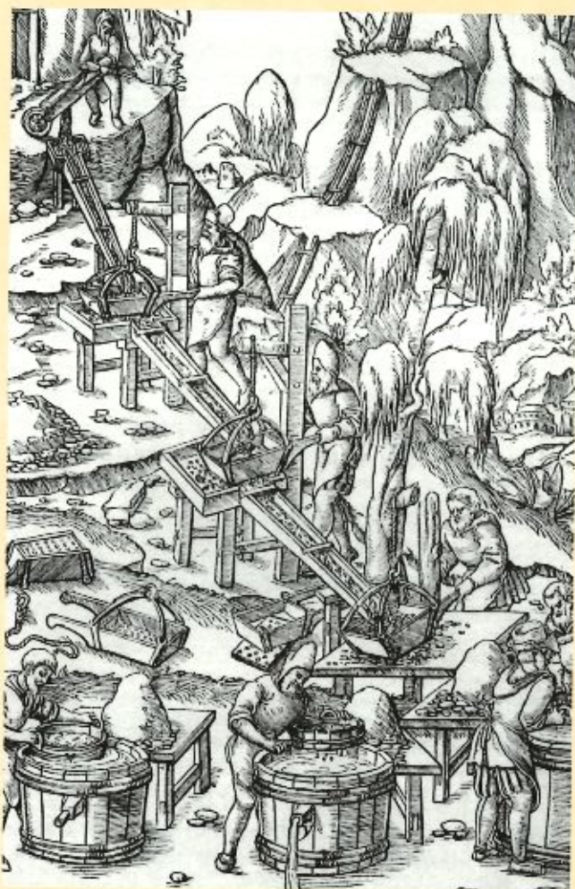
1. Préparation du minéral par tamisages successifs, planche tirée du De re metallica , Georg Bauer dit Agricola, posthume, 1556. Malgré quelques innovations, le travail dans les mines reste très dur avec des outils rudimentaires tels que masses, marteaux, barres de fer et coins de bois.
