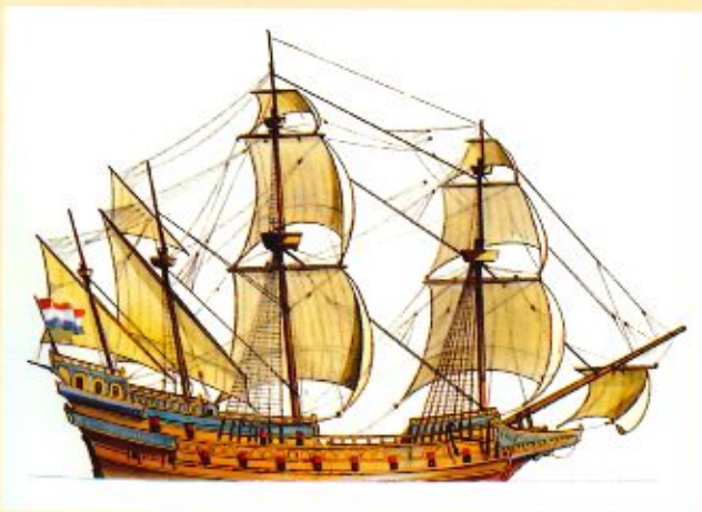
3. Un gallion à quatre mâts du XVI e siècle, dessin. La caraque donne naissance au gallion, plus long, plus large, plus lourd, sans gaillard avant, avec quatre mâts, souvent muni de sabords pour porter une puissante artillerie sous les ponts.
