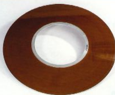
4. Disque dur et un des disques intérieurs, après 1956, la Maison des Écritures, Abbaye de Maredsous, Denée et Musée de la Radio et des Télécommunications, Trooz. IBM commercialise à partir de 1956 des disques durs. Ce disque dur contient des disques en aluminium recouvert d'une couche magnétique dans laquelle peuvent être enregistrées (stockées) les données.
