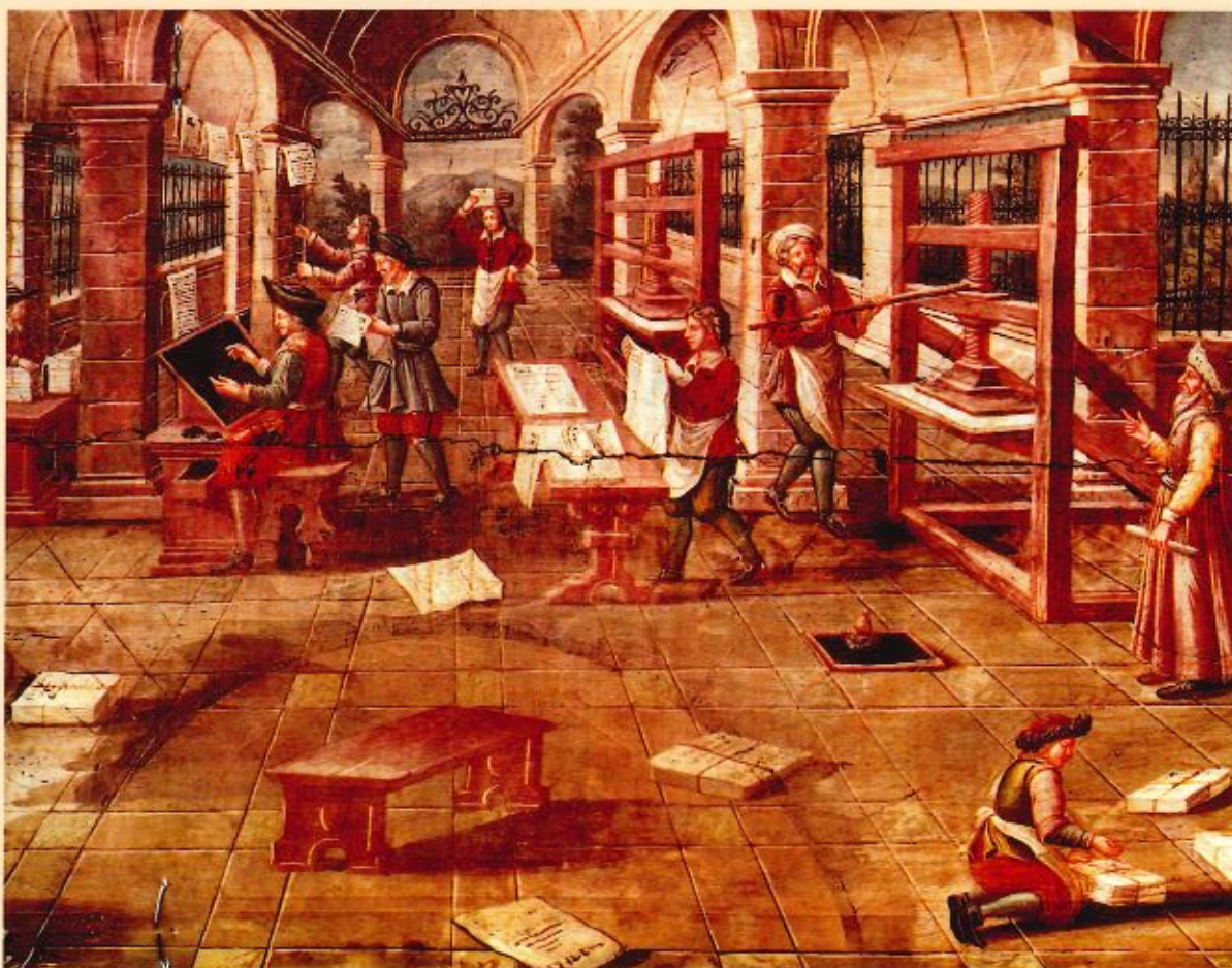
7. Un atelier d'imprimerie, manuscrit du XVI e siècle. On constate les différentes étapes de l'impression : 1. les typographes sur la gauche placent les caractères en métal pour composer une plaque ou page. 2. La plaque est enduite d'encre épaisse au moyen d'un gros tampon de cuir. 3. Les plaques sont pressées sur une feuille de papier à l'aide d'une presse en bois (sur la droite). 4. La feuille imprimée est relue. 5. Les feuilles sont mises à sécher sur un fil. 6. Elles sont ensuite rassemblées en ballots à l'avant-plan à droite.
