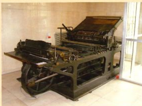
6. Presse rotative. Cette nouvelle presse permet l'impression de 7000 feuilles à l'heure. Le principe est d'imprimer sur des rouleaux de papier qui sont dirigés par la rotation des cylindres. Auparavant, à chaque impression, le margueur devait disposer chaque feuille au millimètre près sur la presse ; ce travail est inutile. C'est un gain de temps considérable.
