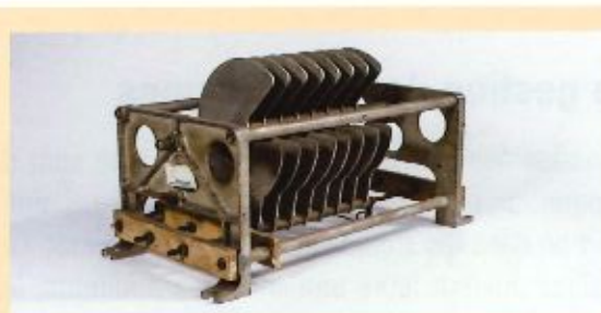
5. Condensateur variable, métal, Musée de la Radio et des Télécommunications, Trooz. Les signaux radioélectriques se propagent dans l'air sous forme d'ondes (vagues). Celles-ci ont des crêtes et des creux, dont la distance détermine l'amplitude. L'intervalle qui sépare deux crêtes donne la longueur d'onde. La fréquence est le nombre d'intervalles par seconde, mesurée en hertz. Le condensateur variable permet de rechercher des fréquences.
