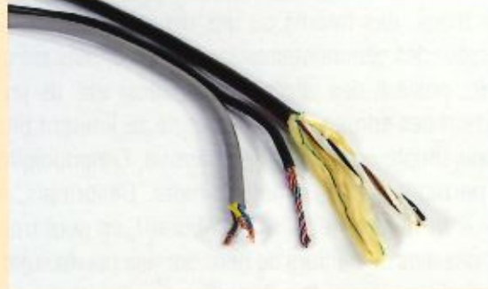
4. Câble en cuivre, câble UTP torsadé et câble en fibre optique. Chaque nouvelle technique permet d'améliorer l'efficacité de la transmission.
